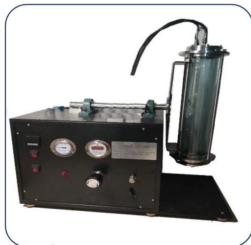
该仪器可以加温, 最高温度 180 摄氏度, 设计成翻转式结构, 方便操作和清洗。
