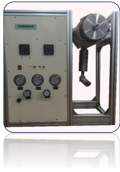
该仪器按照美国（API）推荐程序，另外增加了堵漏压力反排装置，其目的是检测封堵成功后反向破坏封堵所需的力，以便研究封堵材料的结构强度，为堵漏材料的选择提供更可靠依据。此外，该仪器还具有体积较小、结构简单，使用方便，能模拟测定不同状态下的漏失参数。
