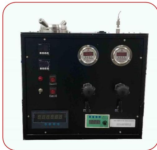
0.8mm 的裂缝。采用氮气加压,最高压力 12MPa,最高温度 260 摄氏度。(如需要 300 摄氏度可令配备 300 摄氏度密封圈以及特殊回压装置,参考超高温高压失水仪)。该仪器可以放置筛网和筛网组合、筛网和岩芯组合、筛网和砂层组合进行测试。该仪器采用数字控温技术,控温精度 0.1 摄氏度。
