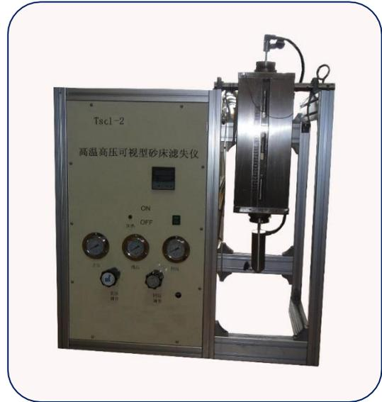
气体进入钻井液杯中上部, 测量开始。仪器的过滤面积为 3165mm<sup>2</sup>。压力大小由气瓶上的压力调节管汇来控制。透过杯体两侧的透明观察窗, 可视窗游标尺, 可以观察到钻井液在沙床中的渗透深度。
