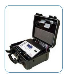
电压,导通了两个电极,使得两者间的电流迅速增加。当电流增加到 61uA,此时的峰值电压就会被记录并显示成钻井液或其他材料的电稳定性。
